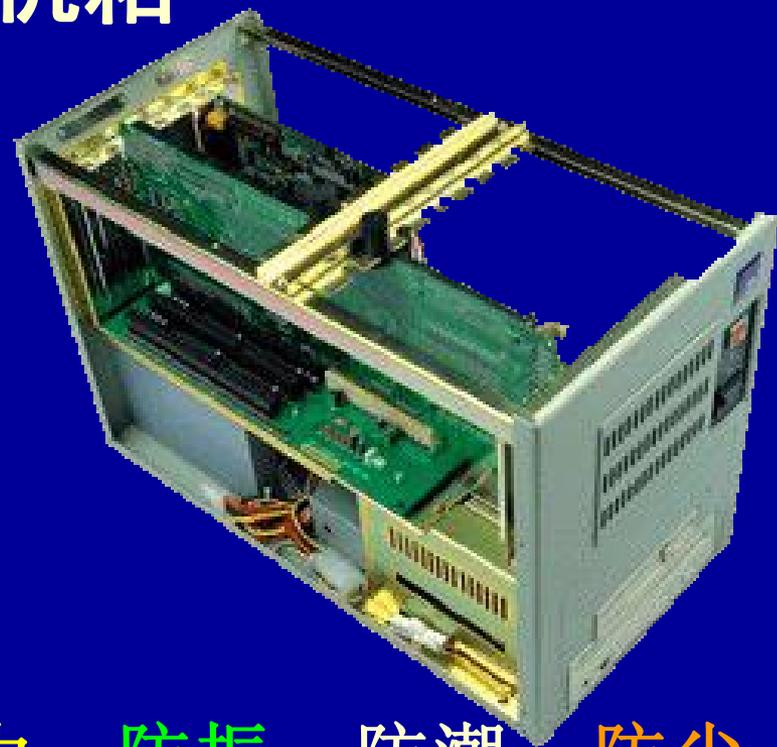
工控机的抗电磁干扰能力、防振、防潮、防尘能力均较强，有较多的扩展槽，它的电源系统有较好的抗电磁干扰能力。虽然工控机的价格比个人电脑贵，但可靠性强得多，性能价格比高，适合在工业现场条件较恶劣的场合使用。
