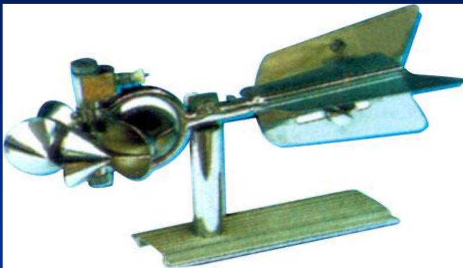
旋杯式流速仪
