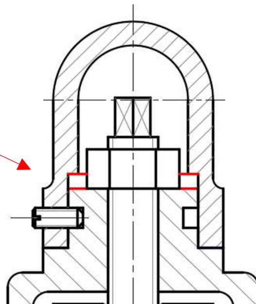
不接触表面用两条图线，
