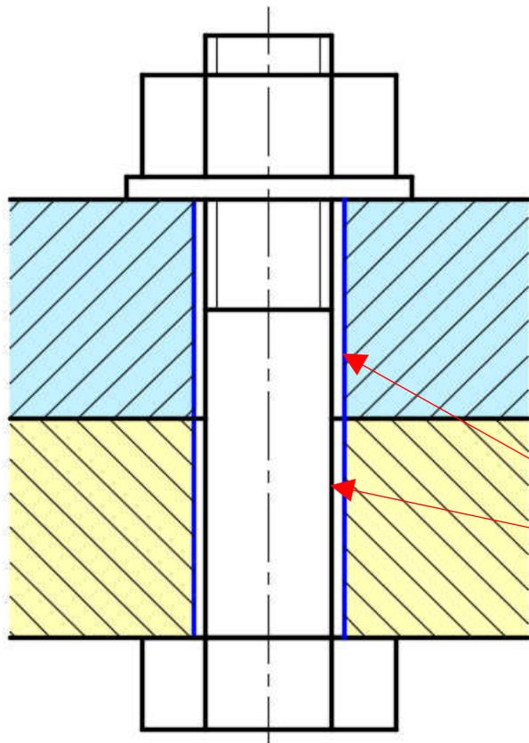
如果不接触表面两条线间隙很小，则必须将其夸大画成两条线。
