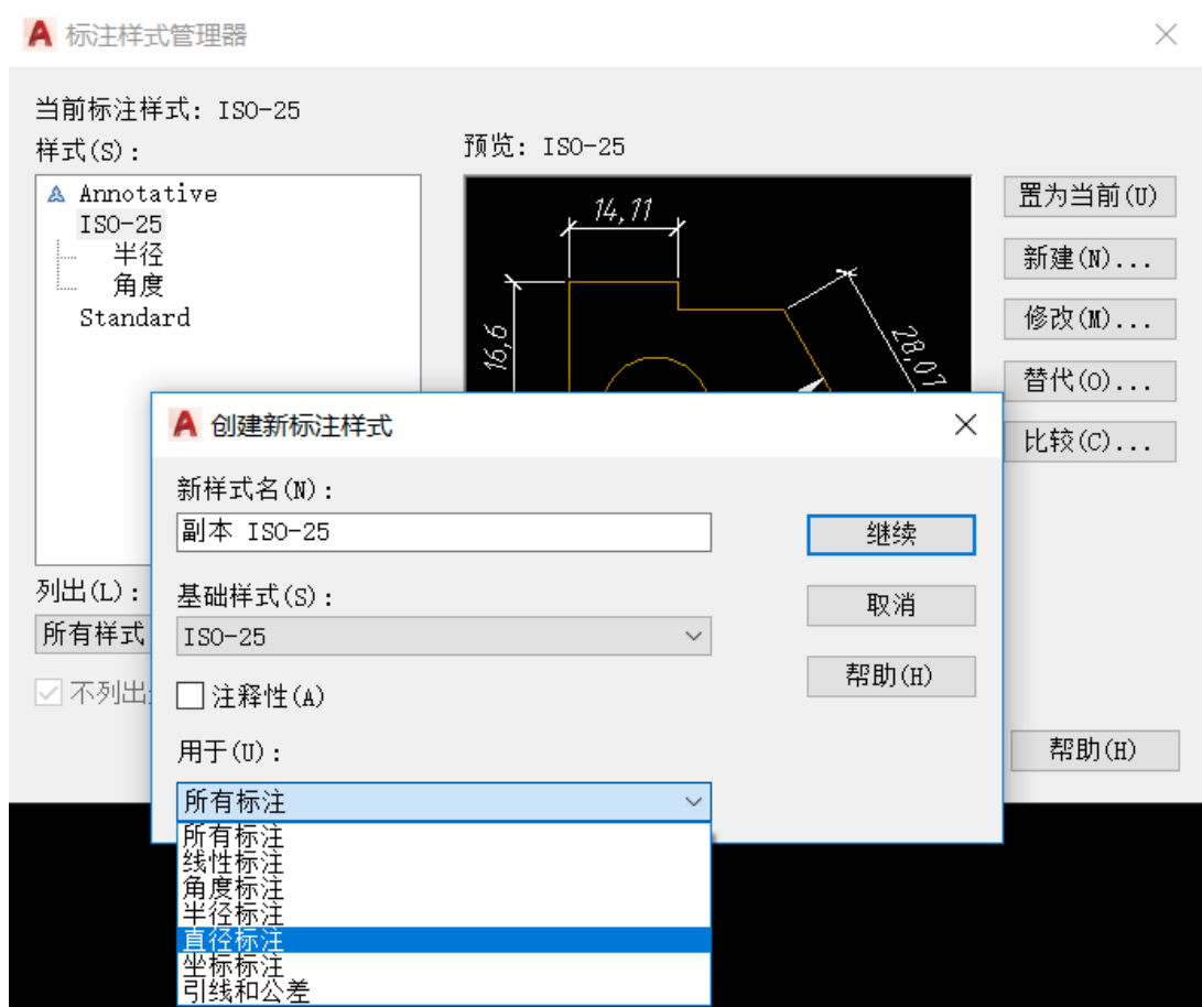
图 5-41 在基础样式 ISO-25 下新建，用于“直径标注”子样式
