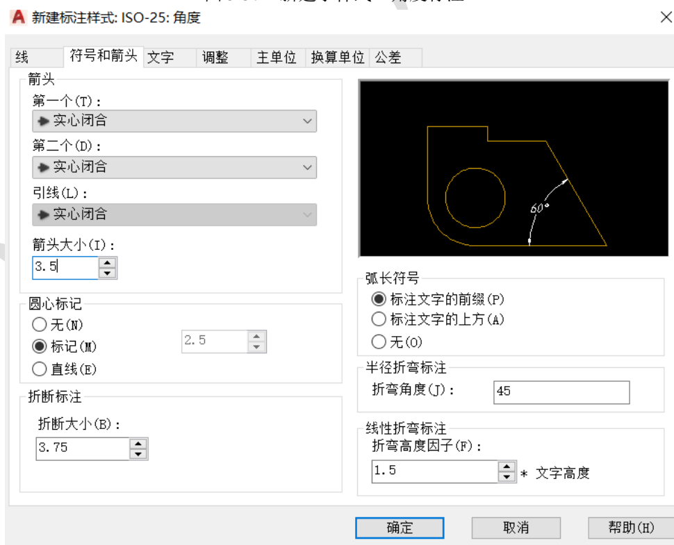
图 5-38 修改“角度标注”子样式的箭头形式为“实心闭合”
