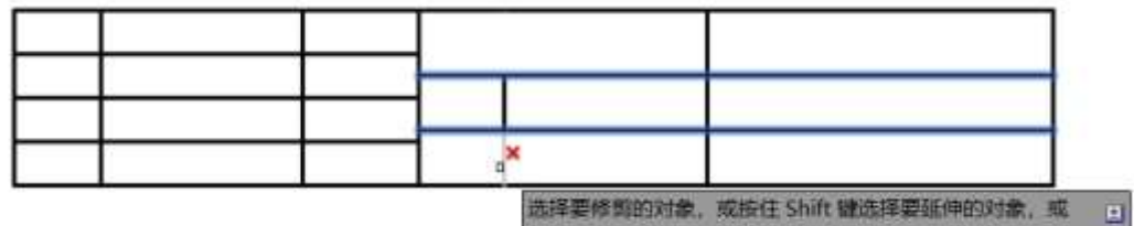
图 5-30 绘制标题栏（修剪上下线段）
