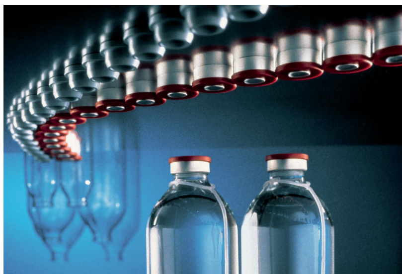
Abb. 15 Der weitgehend gasundurchlässige Butylkautschuk wird nicht nur für die Herstellung schlauchloser Reifen verwendet, sondern auch zur Herstellung von Pharmastopfen. Hier zählt sich zudem aus, dass dieser Kautschuk auch ohne Weichmacher nicht versprödet. Durch sein weitgehend gesättigtes Molekülrückgrat ist das Elastomer obendrein weniger empfindlich gegenüber Chemikalien und die Sterilisation bei hohen Temperaturen.
