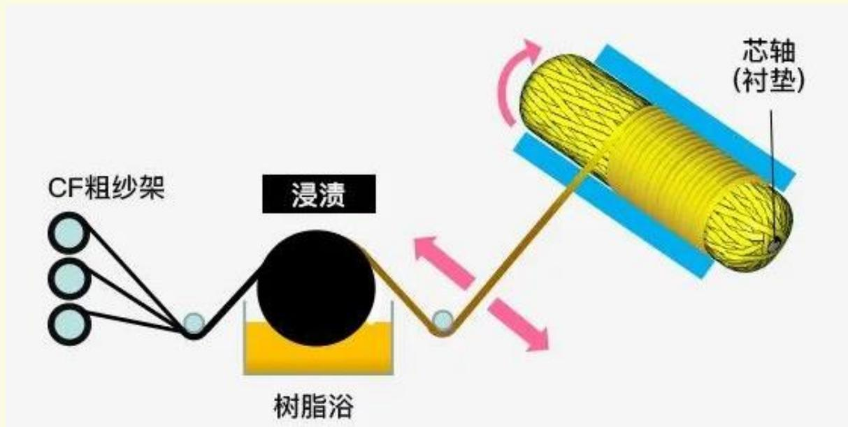
图12.24 缠绕成型工艺示意图
