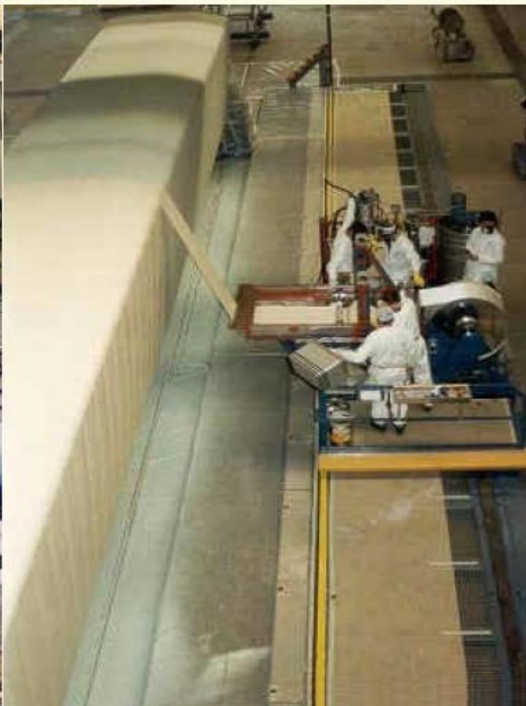
**图12.27 环向缠绕成型制品**
