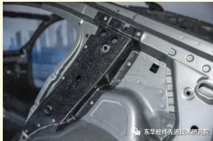
**图12.13 BMWi3 车架中碳纤维部件**
