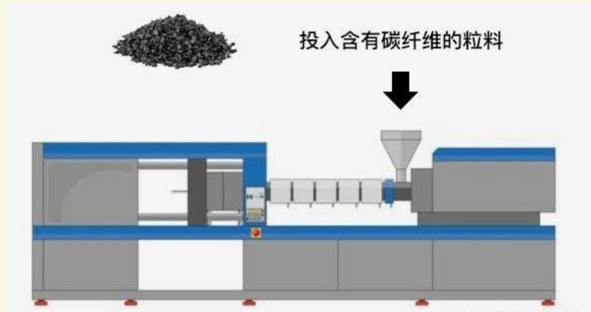
图12.38 注射成型示意图
