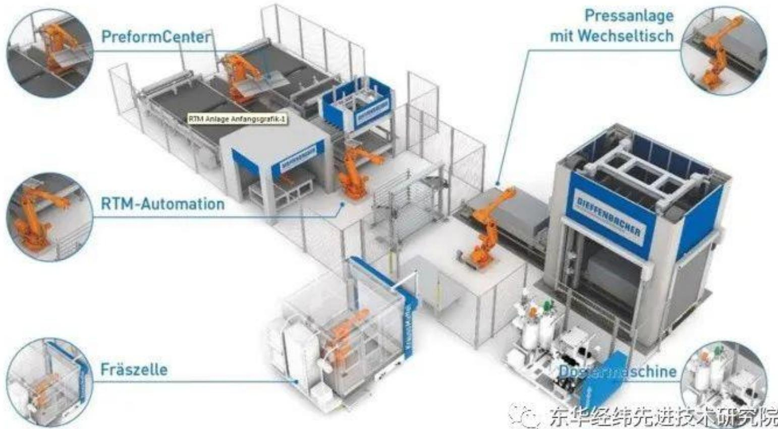
图12.15 HP-RTM成型设备
