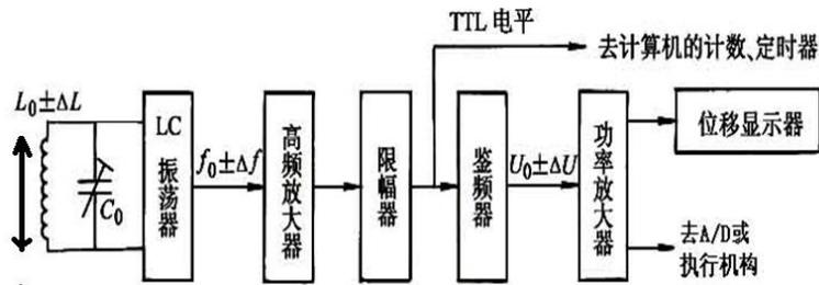
3、电感差动变压器位移传感器
