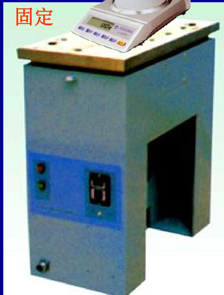
将被测仪器（如图中的电子天平）固定在振动台上，逐渐增大振幅，测试在不同频率的规定振幅下，产品指标是否变化。
