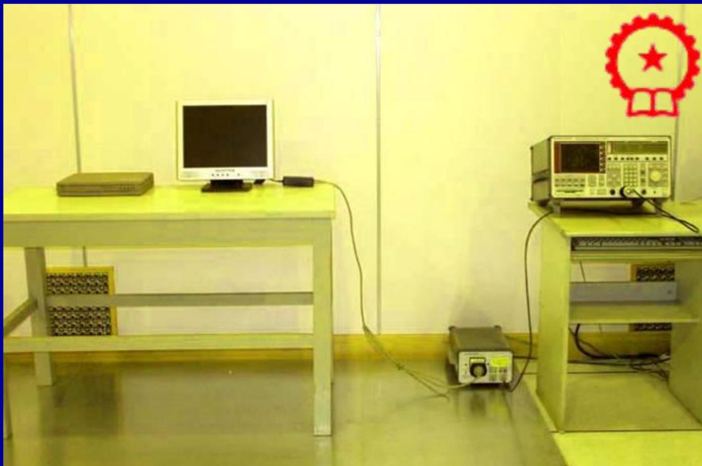
干扰源将高压电火花信号迭加到被测仪器的电源线上，再测试此时仪器性能的变化。
