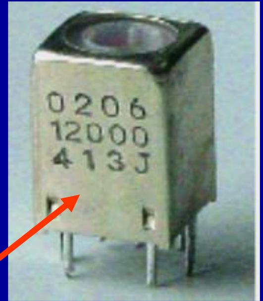
加屏蔽罩后的中频变压器
