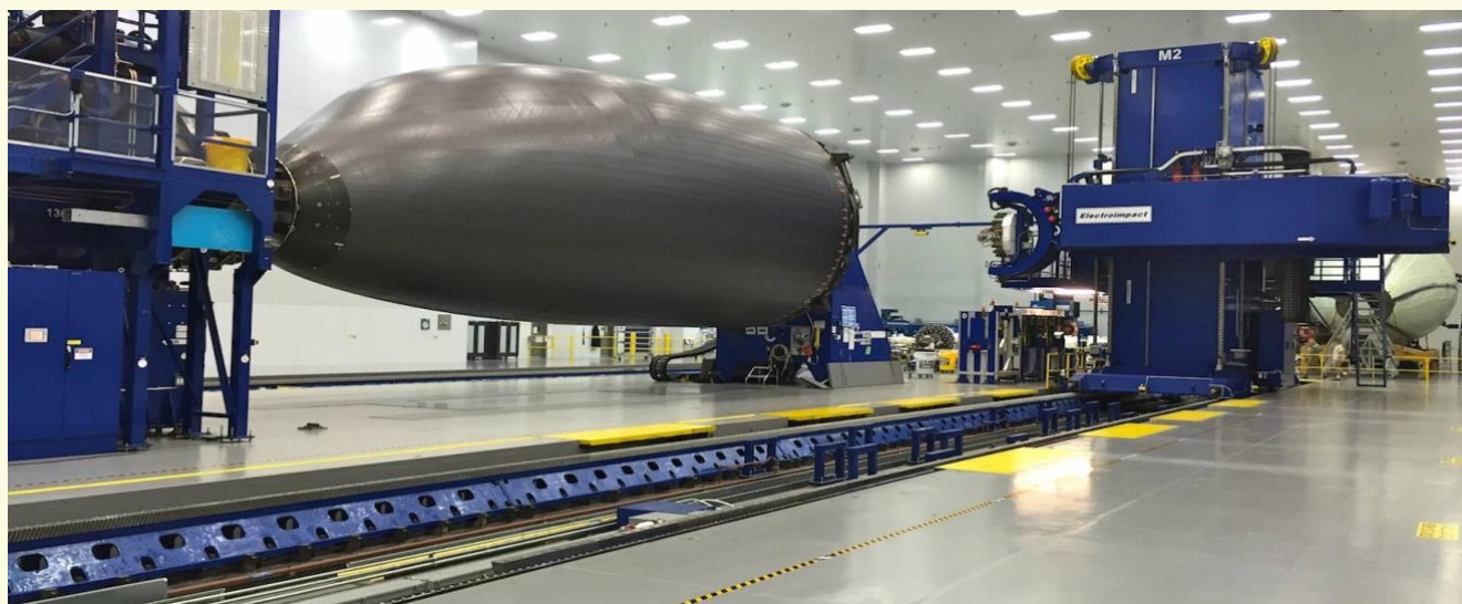
波音787直径5.8米整体成型CFRP框段
