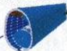
机身尾段 (19段)采用 CFRP复合材料
