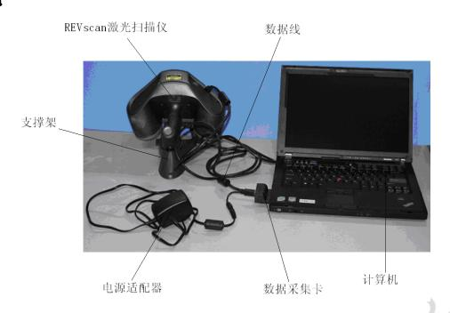
注意: REVScan扫描仪是高精密的光学设备,所以在组配和测量过程中避免碰撞扫描仪,否则会降低扫描的精度,甚至可能损坏扫描仪。
