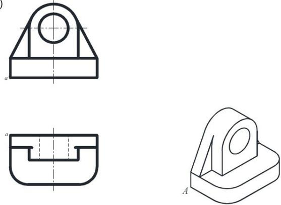
4-2 根据给出的视图画出正等轴测图，尺寸在视图上直接量取。
