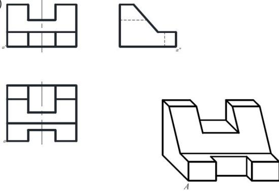
4-3 根据给出的视图画出斜二轴测图，尺寸在视图上直接量取。
