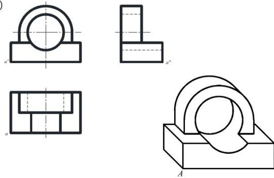
4-4 根据给出的视图画出斜二轴测图，尺寸在视图上直接量取。
