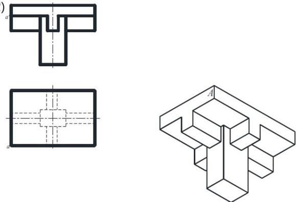
4-3 根据给出的视图画出斜二轴测图，尺寸在视图上直接量取。
