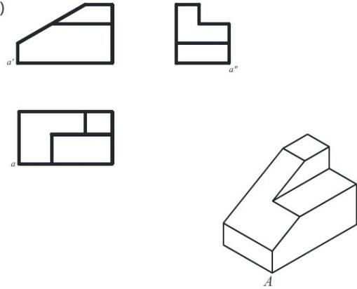
4-1 根据给出的视图画出正等轴测图，尺寸在视图上直接量取。 4-1 根据给出的视图画出正等轴测图，尺寸在视图上直接量取。
