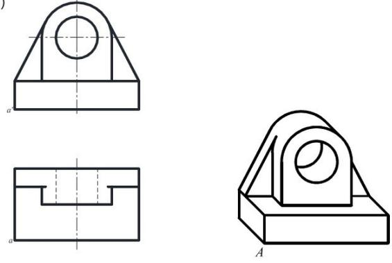
4-4 根据给出的视图画出斜二轴测图，尺寸在视图上直接量取。
