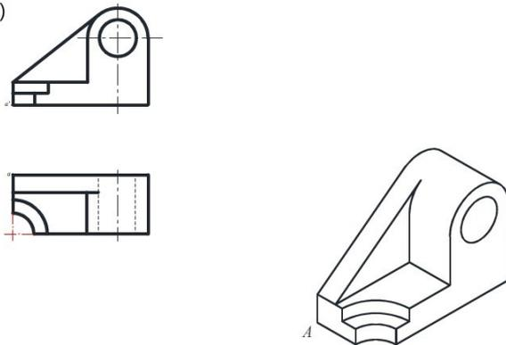
4-2 根据给出的视图画出正等轴测图，尺寸在视图上直接量取。
